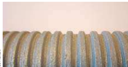
Fot. 5. Gwint trapezowy podstawki śrubowej
