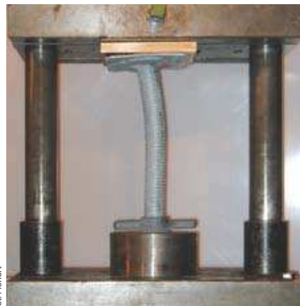
Fot. 6. Badanie wytrzymałościowe podstawki śrubowej rusztowania ramowego RR-0,8 firmy Pionart
