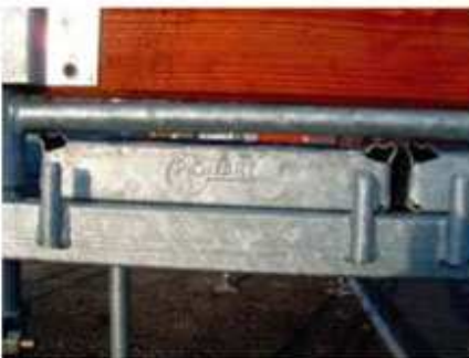
Fot. 2. Cechowanie pomostów stalowych
