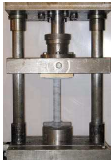
Rys. 1. Stopa śrubowa przygotowana do próby obciążania
