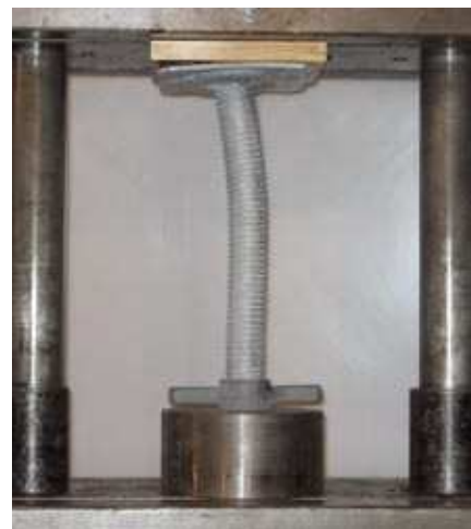
Rys. 2. Stopa śrubowa po próbie maksymalnego obciążania
